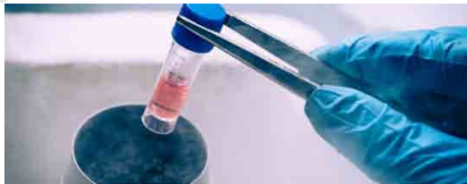
شکل ۱۰- قرار دادن کرایوویال در تانک ازت
